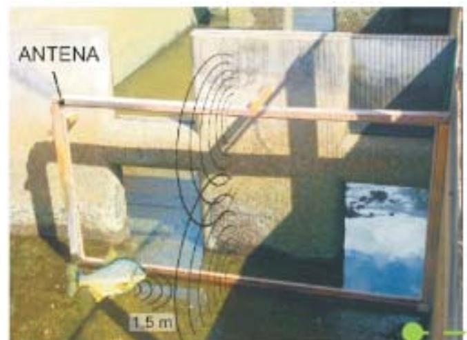
**Fig. 4.** Esquema do campo magnético gerado pela antena e a aproximação de um peixe marcado.
